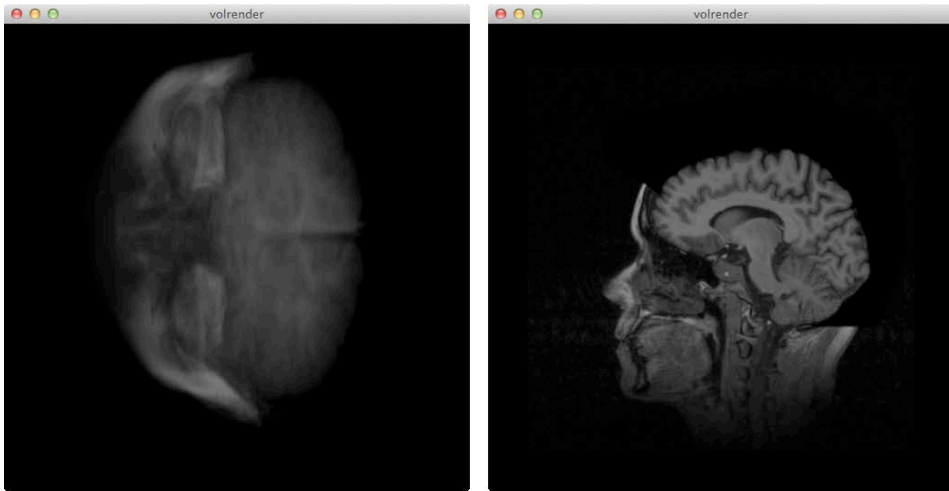
图 11-6 volrender.py 运行示例。左侧的图像是体渲染，右侧的图像是二维切片
