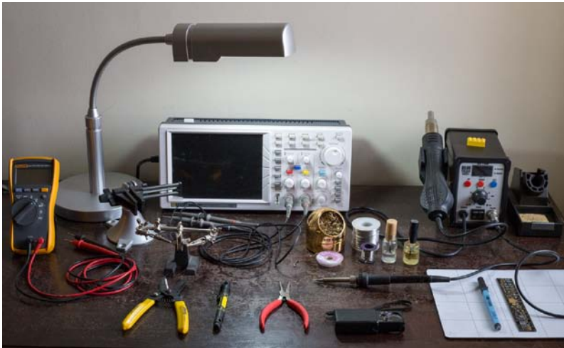
图 B-2 典型的电子工作台，有万用表、工作灯、夹具、剥线钳、螺丝刀、尖嘴钳、放大镜、焊锡、焊剂、示波器和焊接台
